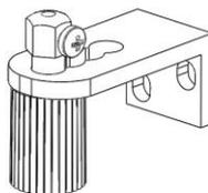
1. Für richtige Auswahl der Platzierung vom Befestigungswinkel und seinem Anschrauben, ist es nötig, die Abspannmutter des Spannungsmechanismus bis zum Rande des Gewindes von der Spannungsschraube zu lösen. (abschrauben)
