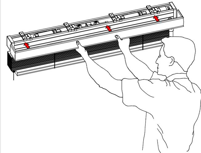
Abb. 9 - Spanschuhmontage bei Seitenführung
