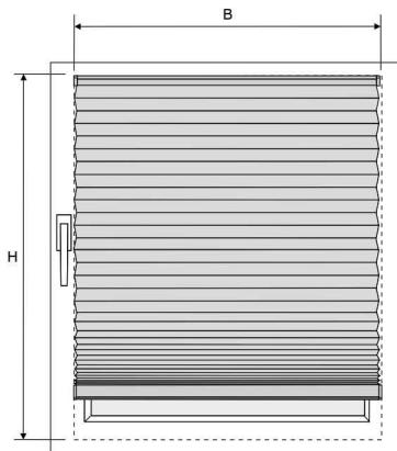
Bei der Montage mit Klemmträgern ist das Bestellmaß **H** (Höhe) die Höhe des Fensterflügels.
